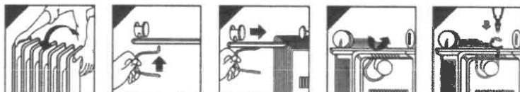
Die Flügelmuttern aufschrauben, fest anziehen, damit die Laufrollenbrücken an den Radiatorkörper richtig befestigt werden.
